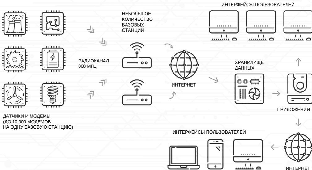
Софиот™ МЛ-1.3 — универсальное устройство сбора и передачи данных (УСПД), краеугольный камень при построении умных систем телеметрии для всех, кто хочет иметь самую актуальную и подробную информацию о том, что происходит в его распределительной ресурсоснабжающей сети.
